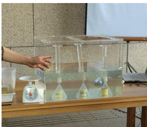
写真 3. 土入り容器を水槽に沈めて土の空気の容量を測定する実験.
