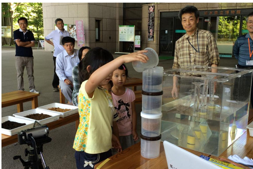
写真 4. 層に分かれた土が雨の水を保つ働きを確かめる実験.
